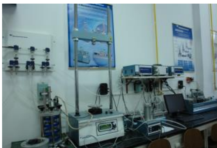
Testare triaxială în condiții UU/CU/CD
