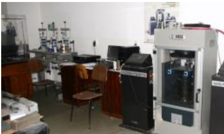
Determinarea rezistenței la compresiune uniaxială
