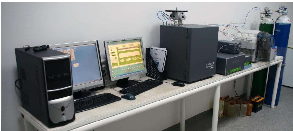
Picarro-CRDS – CO 2 cuplat cu modul de combustie și Aurora 1030W
