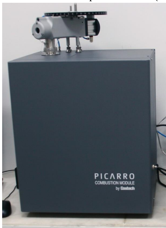
Modul de combustie și autosampler pentru Picarro-CRDS – CO 2
