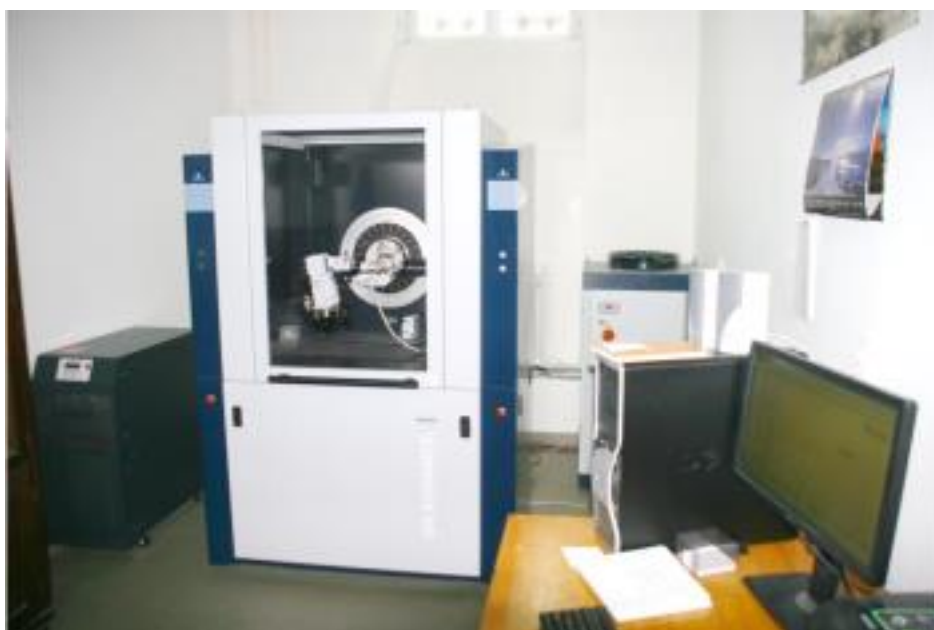
Bruker D8 ADVANCE – cu configurație DAVINCI
